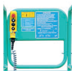
Siirrettävä ohjausyksikkö mahdollistaa helpon ja turvallisen koneen käytön. Ohjausyksikkö on varustettu virta-avaimella, painonapeilla ja hätäseis-painikkeella
